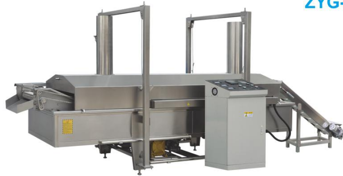
LXYG-D 自动连续油炸线 Continuous Frying Line
